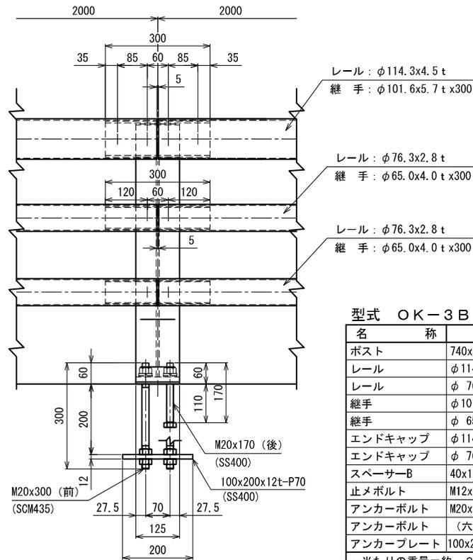
型式 OK-3Bs-75 (B種) 材料表 (ポストピッチ2m 片側20.5m当たり) (鋼製)
